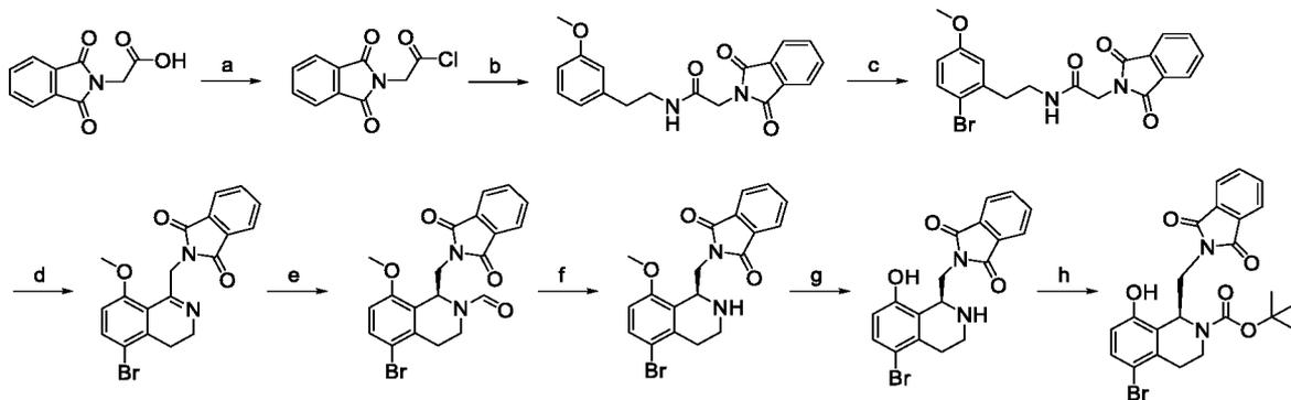
**Схема 1:** а) SOCl<sub>2</sub>, EtOAc; б) 2-(3-метоксифенил)этан-1-амин, Et<sub>3</sub>N, DCM; в) NBS, DMF; д) P<sub>2</sub>O<sub>5</sub>, MeCN; е) димер хлорида бензолрутения(II), (1*S*,2*S*)-(+)-*N*-*n*-тозил-1,2-дифенилэтилендиамин, Et<sub>3</sub>N, HCO<sub>2</sub>H, MeCN; ф) HCl, THF; г) BBr<sub>3</sub>, DCM; h) Boc<sub>2</sub>O, DCM.
