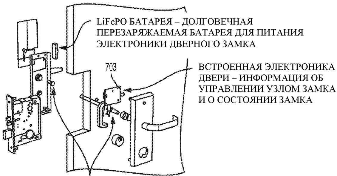
LiFePO БАТАРЕЯ – ДОЛГОВЕЧНАЯ ПЕРЕЗАРЯЖАЕМАЯ БАТАРЕЯ ДЛЯ ПИТАНИЯ ЭЛЕКТРОНИКИ ДВЕРНОГО ЗАМКА
