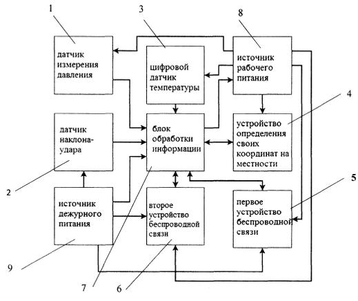
Устройство для снятия параметрических данных с ёмкостей для сбора твердых отходов (2 варианта), вспомогательное периферийное устройство для устройства снятия параметрических данных с ёмкостей для сбора твердых отходов, система для мониторинга наполнения ёмкостей для сбора твердых отходов (2 варианта)
