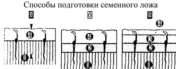
а – предпосевная обработка почвы на глубину заделки семян; б – предпосевное прикатывание взрыхлённого слоя почвы; в – предпосевное и послепосевное прикатывание взрыхлённого слоя почвы; 1-слой почвы ниже дна бороздки; 2 – уплотнённая часть взрыхлённого слоя почвы; 3 – уплотнённая часть слоя почвы с семенами после посева; 4 – верхний рыхлый слой почвы.
