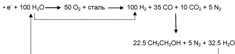
Обеспечение интеграции процессов - процесс электролиза с процессом BOF и процессом ферментации - приводит к получению этанола и уменьшению выбросов CO<sub>2</sub> в качестве побочных продуктов.
