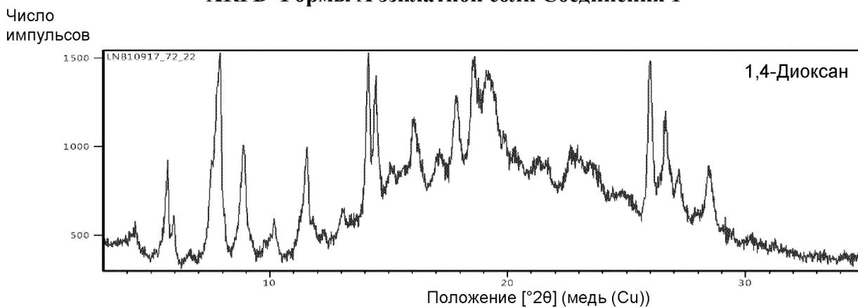
**ФИГ. 120****XRPD Формы В эзилатной соли Соединения 1**
