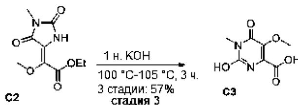
**[0078]** В круглодонную колбу объемом 2000 мл помещали этил-2-метокси-2-[(4E)-1-метил-2,5-диоксоимидазолидин-4-илиден]ацетат (2) (80,00 г, 350,6 ммоль, 1,00 экв.), гидроксид калия (1 М в воде) (1400,0 мл). Полученный раствор перемешивали в течение 3 часов при 105 °С. Реакционную смесь охлаждали до 0 °С на бане из воды со льдом. Значение pH раствора доводили до 3 с помощью хлороводорода (12 моль/л) при 0 °С, твердое вещество собирали фильтрованием и сушили осадок в вакууме. В результате
