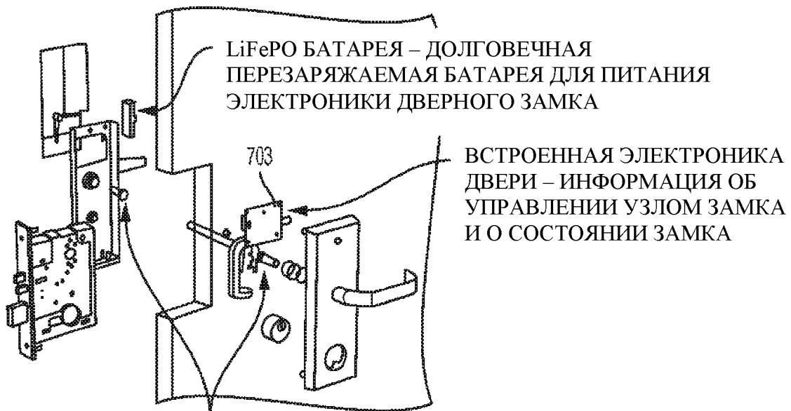
ИЗОЛЯЦИОННЫЕ ВТУЛКИ СТЕРЖНЯ ДВЕРНОЙ РУЧКИ – ОБЕСПЕЧЕНИЕ ДВУХФАКТОРНОГО ЕМКОСТНОГО КАСАНИЯ ДЛЯ ВХОДА
