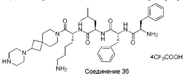
Неочищенный трет-бутил-N-[(1R)-1-бензил-2-[[2(1R)-1-бензил-2-[[2(1R)-1-[[2(1R)-5-(трет-бутоксикарбониламино)-1-(2-пиперазин-1-ил-7-азаспиро[3.5]нонан-7-карбонил)пентил]карбамоил]-3-метил-бутил]амино]-2-оксо-этил]амино]-2-оксо-этил]карбамат (**36D**) (255 мг, 0,27 ммоль) и трифторуксусную кислоту (2 мл) добавляли в реакционную колбу объемом 50 мл и системе позволяли реагировать при комнатной
