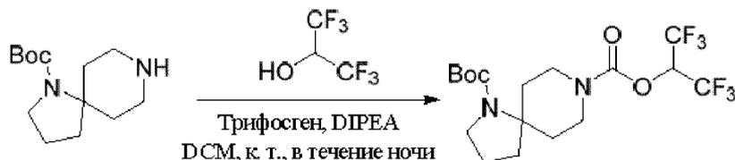
В колбе располагали 1,1,1,3,3,3-гексафторпропан-2-ол (2,00 г, 11,9 ммоль, 1,50 экв.), DCM (20 мл) и трифосген (1,18 г, 3,97 ммоль, 0,50 экв.). Добавляли по каплям N,N-диизопропилэтиламин (2,55 г, 19,7 ммоль, 2,50 экв.) при 0°C. Раствор перемешивали в течение 3 ч. при комнатной температуре. Затем добавляли трет-бутил-
