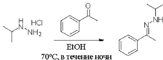
В 250-мл круглодонную колбу помещали 1-фенилэтан-1-он (5,94 г, 49,5 ммоль, 1,00 экв.), пропан-2-илгидразина гидрохлорид (10,9 г, 99,0 ммоль, 2,00 экв.) и этанол (80 мл). Полученный раствор перемешивали в течение ночи при 70°C и концентрировали при пониженном давлении с получением 16,0 г (*E*)-1-изопропил-2-(1-фенилэтилиден)гидразина (неочищенный). LCMS (ESI, *масса/заряд*): 177 [M+H]<sup>+</sup>.
