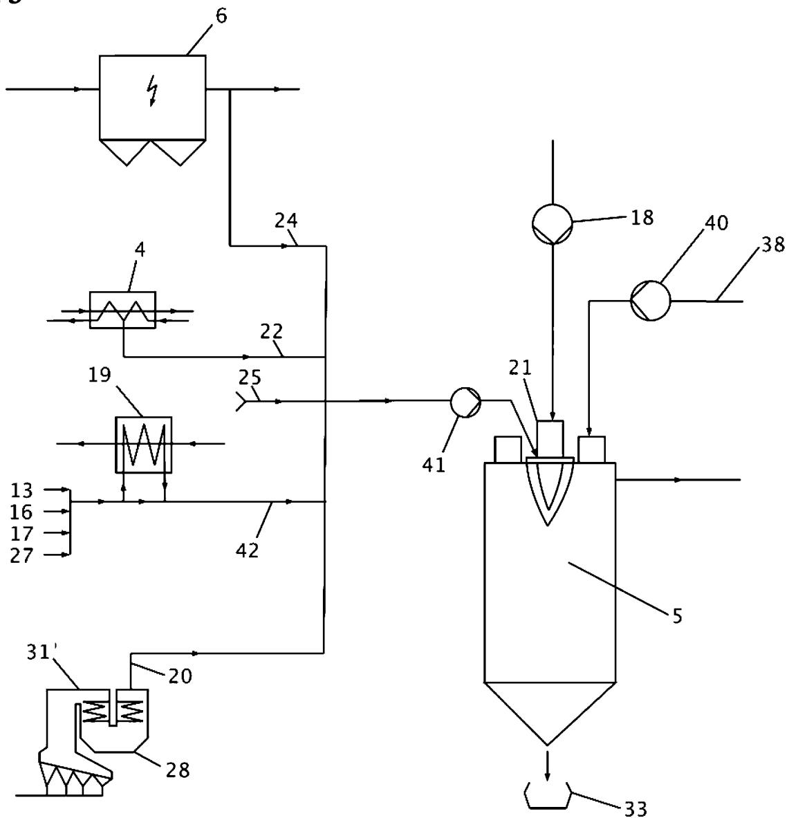
УСТРОЙСТВО И СПОСОБ НЕПРЕРЫВНОЙ СУШКИ СЫПУЧИХ ПРОДУКТОВ, В ЧАСТЬИ, ДРЕВЕСНОЙ СТРУЖКИ ИЛИ ДРЕВЕСНЫХ ВОЛОКОН, С ИСПОЛЬЗОВАНИЕМ МНОГОТОПЛИВНОЙ ГОРЕЛКИ С ОХЛАЖДАЮЩЕЙ МУФЕЛЬ СИСТЕМОЙ
