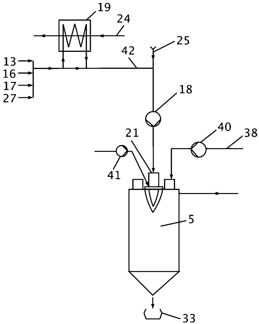
УСТРОЙСТВО И СПОСОБ НЕПРЕРЫВНОЙ СУШКИ СЫПУЧИХ ПРОДУКТОВ, В ЧАСТЬИ, ДРЕВЕСНОЙ СТРУЖКИ ИЛИ ДРЕВЕСНЫХ ВОЛОКН, С ИСПОЛЬЗОВАНИЕМ МНОГОГОЛЛИВНОЙ ГОРЕЛКИ С ОХЛАЖДАЮЩЕЙ МУФЕЛЬ СИСТЕМОЙ
