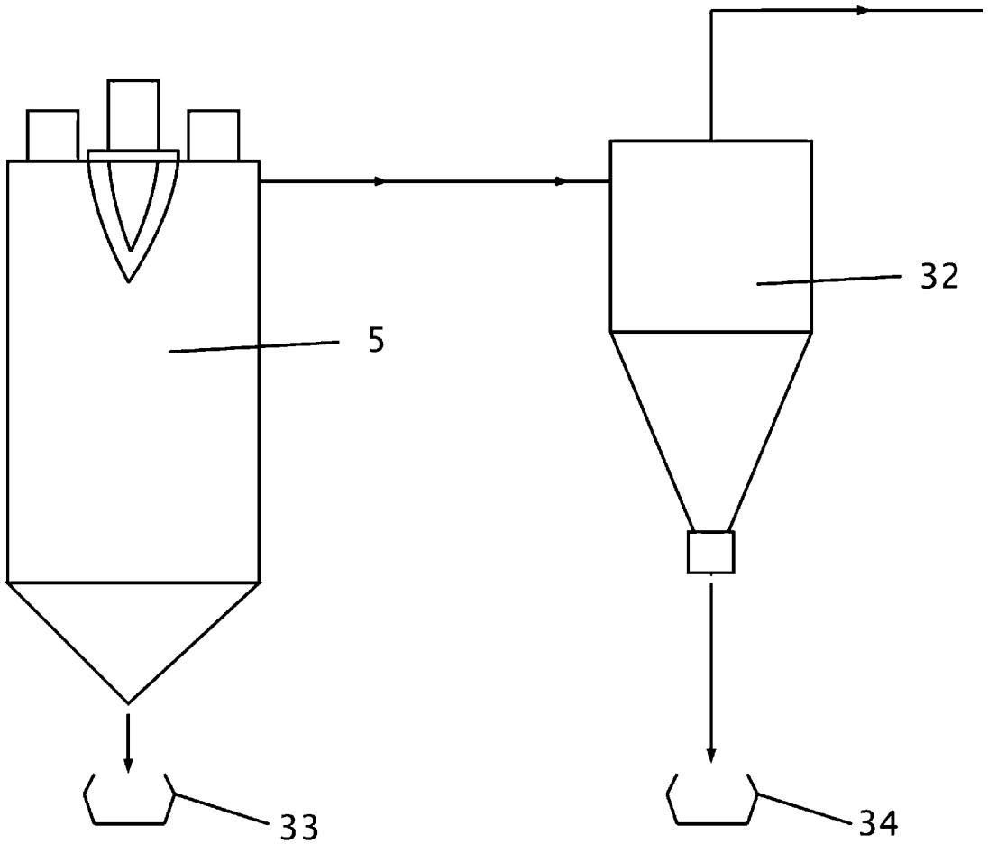
УСТРОЙСТВО И СПОСОБ НЕПРЕРЫВНОЙ СУШКИ СЫПУЧИХ ПРОДУКТОВ, В ЧАСТЬИ, ДРЕВЕСНОЙ СТРУЖКИ ИЛИ ДРЕВЕСНЫХ ВОЛОКОН, С ИСПОЛЬЗОВАНИЕМ МНОГОТОПЛИВНОЙ ГОРЕЛКИ С ОХЛАЖДАЮЩЕЙ МУФЕЛЬ СИСТЕМОЙ
