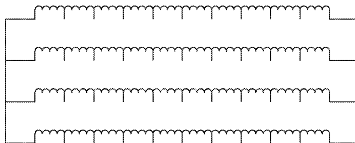
Пример параллельного соединения четырех групп из 10 слоев, соединенных последовательно
