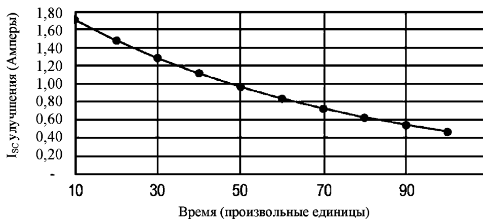
\Delta I_{SC} от частоты следования импульсов
