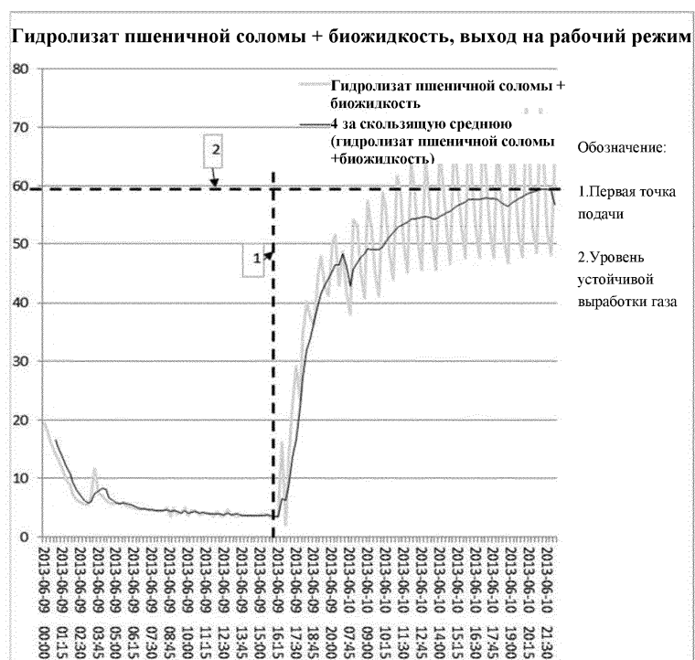
Фиг. 12. Показывает характеристику "выхода на рабочий режим" выработки биометана из биожидкости из гидролизованной пшеничной соломы
