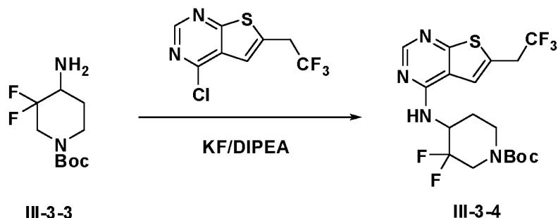
Смесь **III-3-3** (360 мг, 1,42 ммоль), трет-бутил-4-амино-3,3-дифторпиперидин-1-карбоксилата (334 мг, 1,42 ммоль) в изопропаноле (10 мл) перемешивали при кипячении с обратным холодильником в течение ночи. Реакционную смесь концентрировали и остаток очищали на колонке с силикагелем (PE/EA = 2:1) с получением **III-3-4** (110 мг, выход: 17%). ESI-MS  $m/z$ : 453 ( $M+H$ ).
