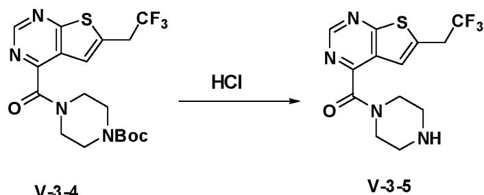
Раствор **V-3-4** (120 мг, 0,3 ммоль) в HCl/MeOH (8 мл) перемешивали при комнатной температуре в течение 2 часов. Растворитель удаляли под вакуумом и остаток разбавляли DCM и промывали NaHCO<sub>3</sub>. Органический раствор промывали рассолом, сушили над Na<sub>2</sub>SO<sub>4</sub> и концентрировали с получением неочищенного **V-3-5** в виде желтого масла (120 мг).
