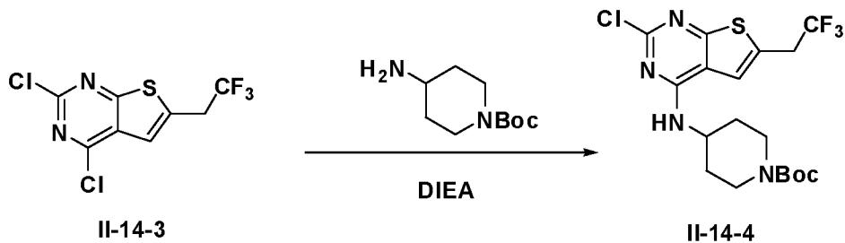
Раствор **II-14-3** (750 мг), трет-бутил-4-аминопиперидин-1-карбоксилат (680 мг) и DIEA (680 мг) в 20 мл THF нагревали с обратным холодильником в течение ночи. Реакционную смесь выливали в воду и экстрагировали  $\text{EtOAc}$ . Объединенный органический раствор сушили и концентрировали. Остаток очищали хроматографией (PE/EA = 5:1) с получением **II-14-4** (500 мг, 42%).
