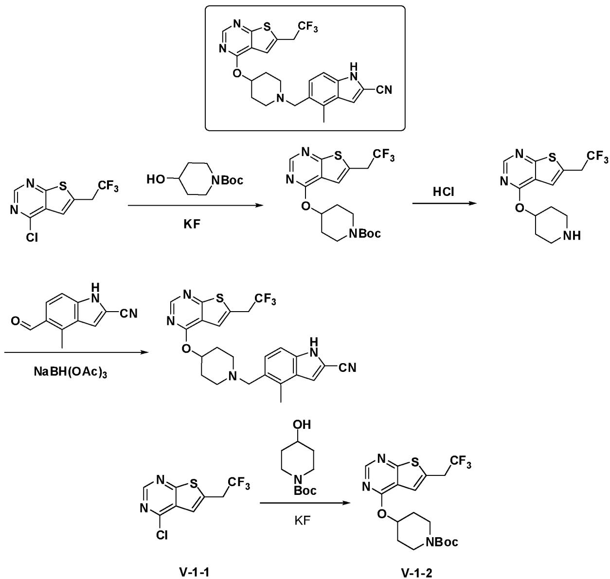
Смесь **V-1-1** (250 мг, 1,0 ммоль), трет-бутил-4-гидроксипиперидин-1-карбоксилата (250 мг, 1,2 ммоль), KF (298 мг, 15,0 ммоль) в DMSO (15 мл) при 100°C в течение ночи. Добавляли воду и реакционную смесь экстрагировали этилацетатом. Органический слой концентрировали и остаток очищали на колонке с силикагелем (PE/EA = 3:1) с получением **V-1-2** (130 мг, выход: 31%) в виде бесцветного масла. ESI-MS *m/z*: 418 (M+H).
