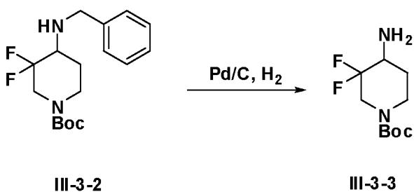
Смесь III-3-2 (500 мг, 1,53 ммоль) и влажного Pd/C (10%) в MeOH (10 мл) перемешивали в атмосфере H<sub>2</sub> при комнатной температуре в течение ночи. Реакционную смесь фильтровали через целит и осадок промывали MeOH и этилацетатом. Фильтрат
